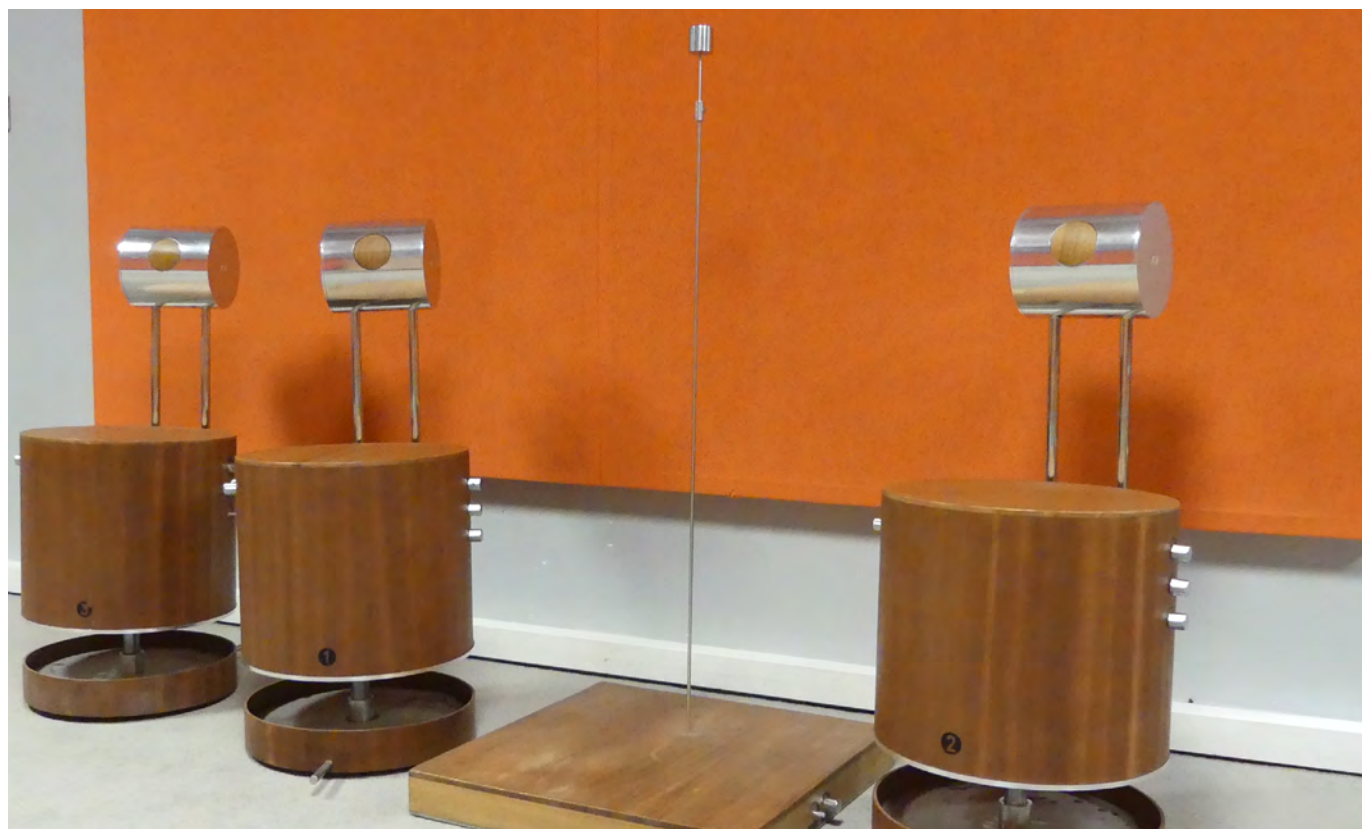
Plancher et chaise vibrants, cylindre à transduction osseuse. © Christophe Rosenberg.
